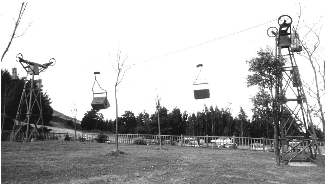
“Tren aéreo” como el que bajaba el mineral de hierro y piedra desde el Arraiz a los cargaderos de Zorroza.
