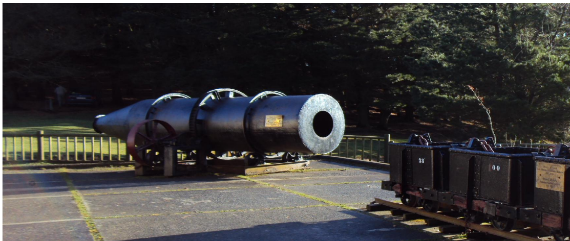
Tromel para lavado del mineral de hierro como el que usó la Mina Amparo. (1940). Centro de Interpretación Ambiental Peñas Negras. Ortuella.
